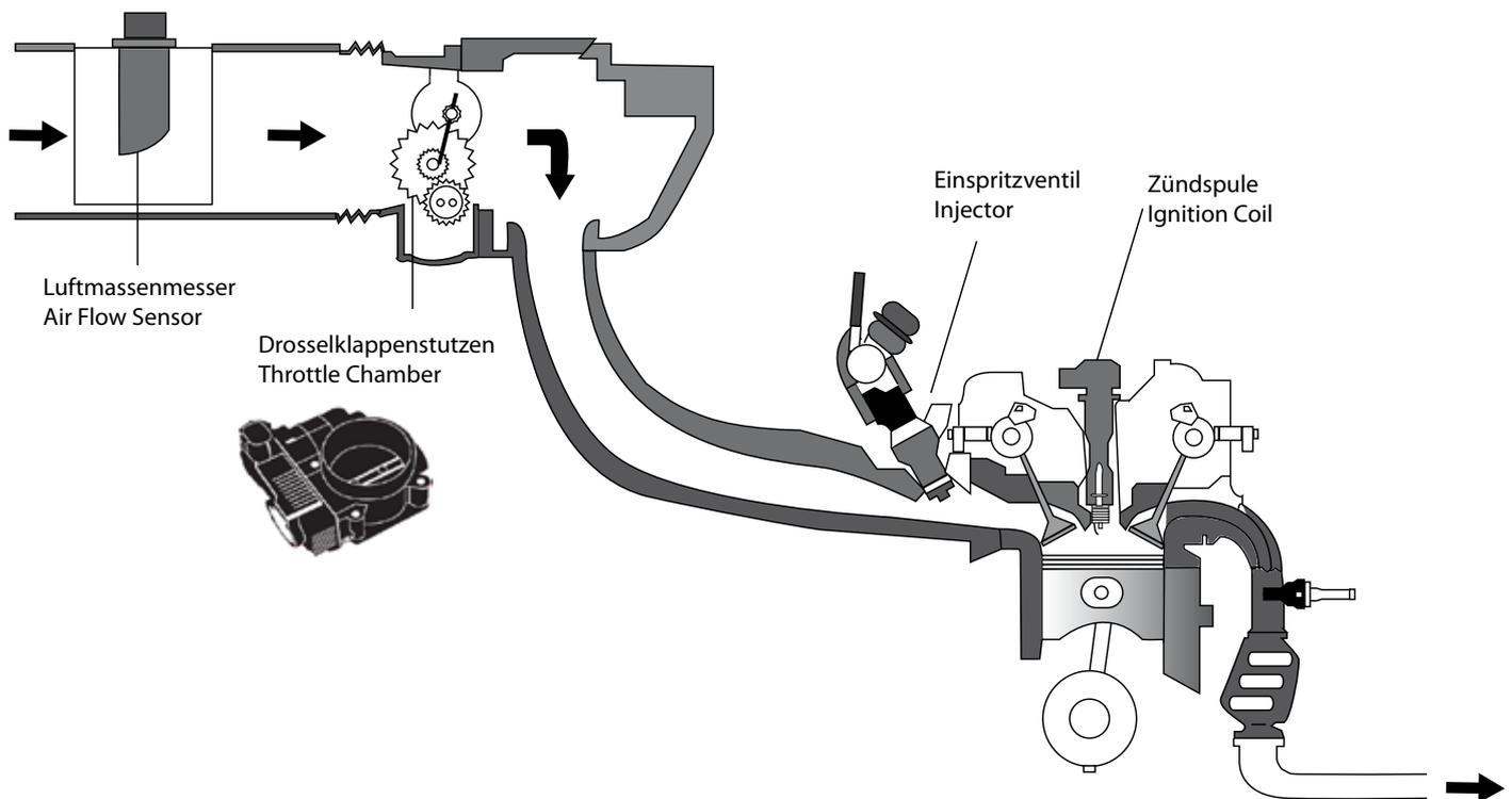
Le valvole farfallate sono montate tra il collettore di aspirazione e il sensore di carico. Regolano il flusso della massa aria aspirata dal motore. Tramite l'angolo di apertura delle valvole viene modificata la miscela di carburante ed aria.
