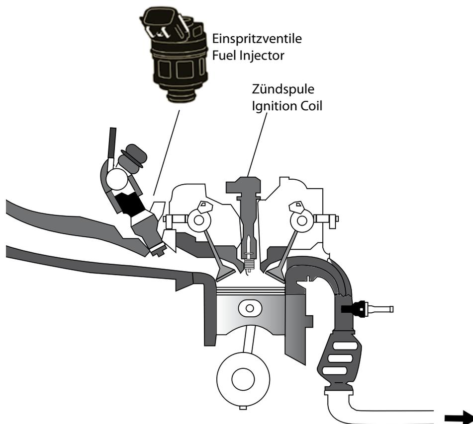
L'iniettore è un componente dell'impianto di iniezione del motore. Ha il compito di inviare e atomizzare il carburante in arrivo avendo come obiettivo di creare una miscela omogenea, del combustibile e aria, all'interno della camera di combustione.
