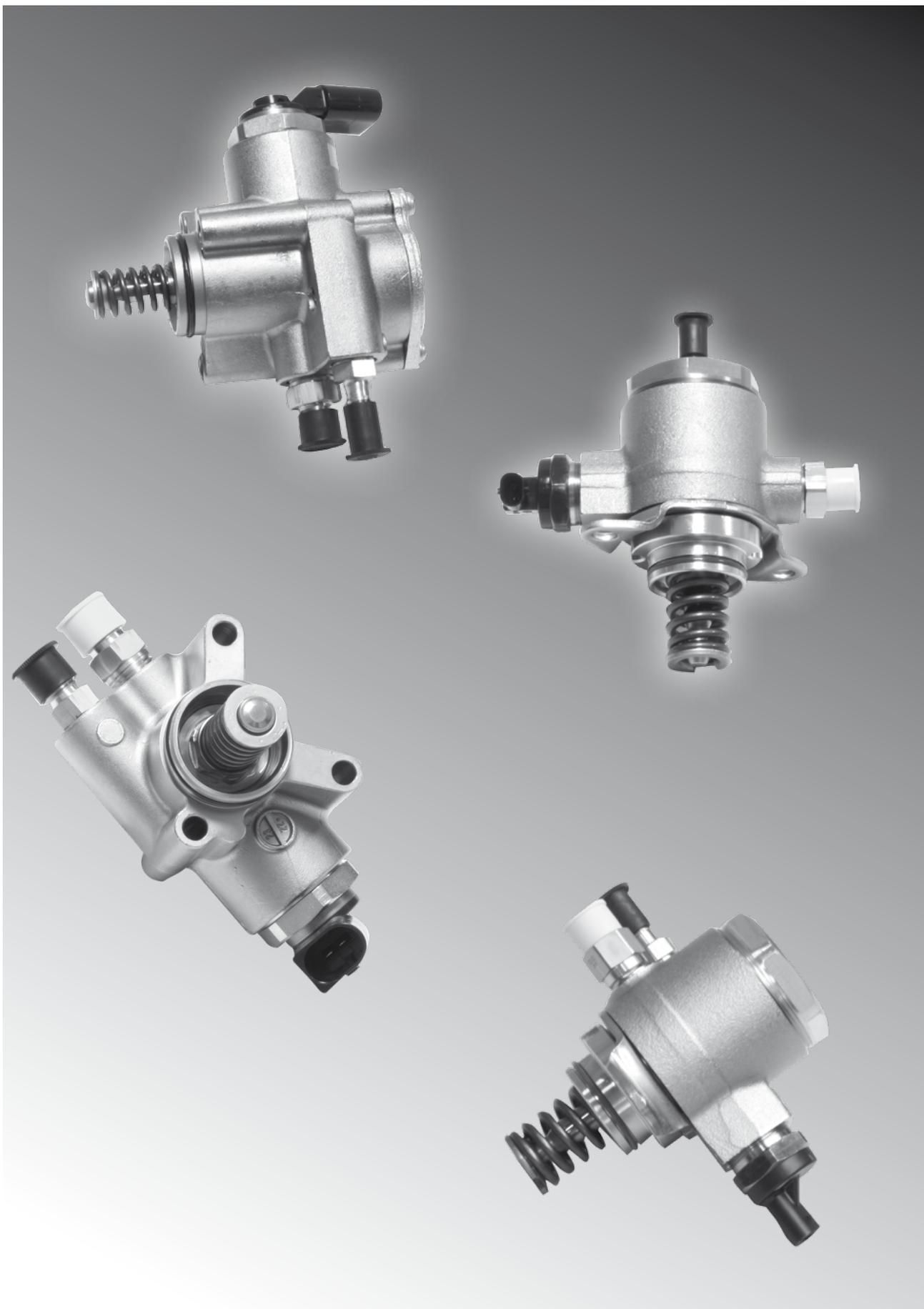
Hochdruckpumpen werden bei modernen Motoren mit Benzindirekteinspritzung verwendet. Eine Benzindirekteinspritzung hat die Vorteile, dass sich bei gleichem Hubraum ein höheres Drehmoment und damit auch eine höhere Leistung einstellt. Der Motor reagiert besser auf Gaspedaländerungen und im Teillastbetrieb ist eine messbare Verbrauchseinsparung vorhanden.
