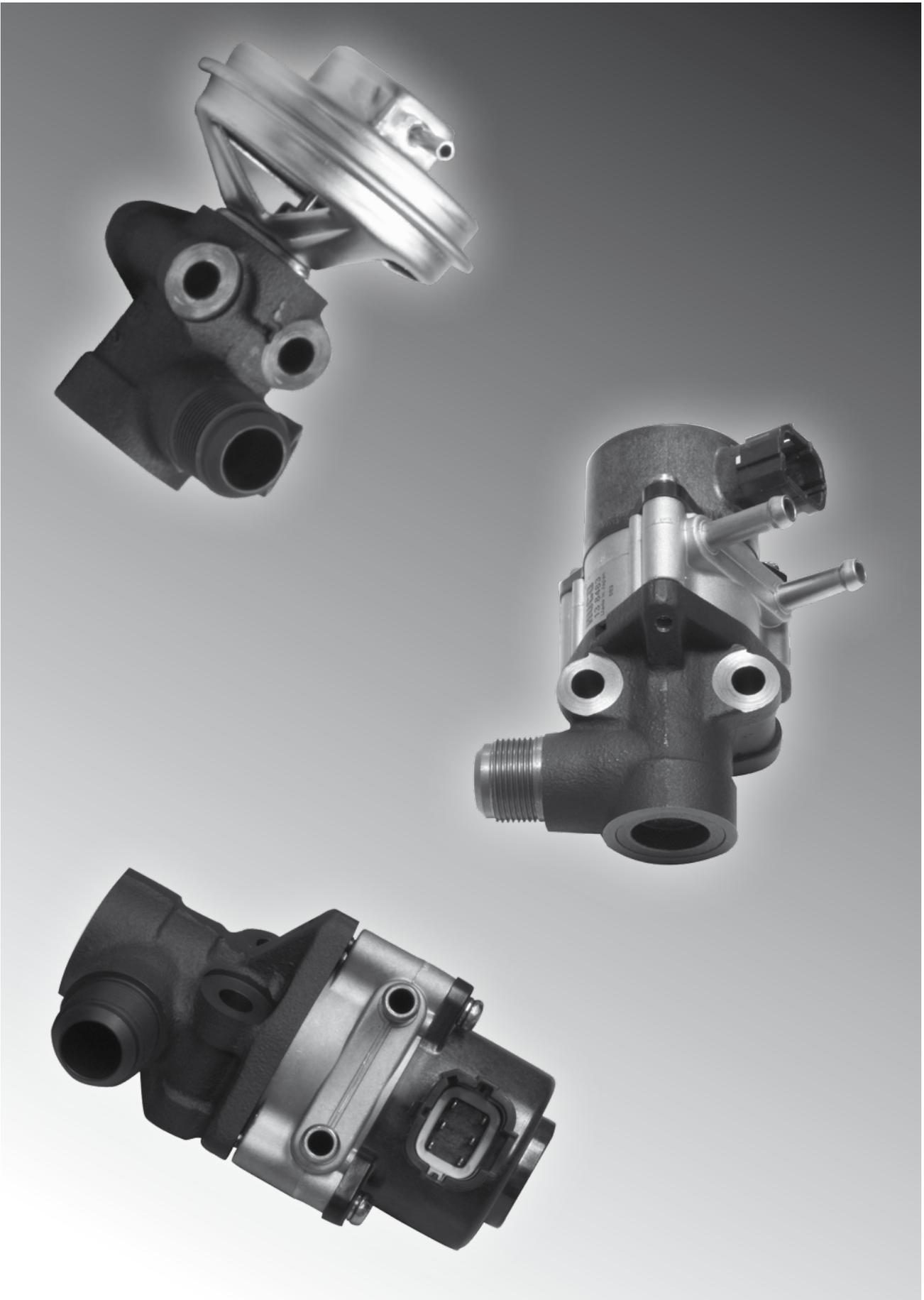
Das Abgasrückführventil ist außen am Motor verbaut. Es verbindet die Abgasseite mit der Ansaugseite. Mit Hilfe der Abgasrückführung wird die Entstehung von NOx bei Otto- oder Dieselmotoren verringert. Die Abgasrückführung findet nur im Teillastbereich statt, da hier der Motor besonders mager läuft. Bei Kaltstart, Warmlauf und Vollast ist eine Abgasrückführung nicht sinnvoll.
