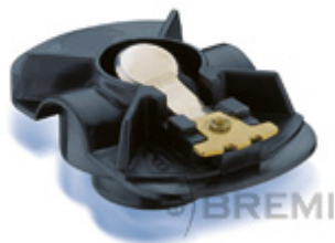
9541 Zündsystem / system Mitsubishi Polyester/Polyester nicht entstört/not suppressed Verwendung für: / applicable for: MAZDA MITSUBISHI
