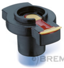
7381 Zündsystem / system Ducellier Polypropylen/Polypropylen 5000 Ohm entstört/suppressed Verwendung für: / applicable for: FIAT RENAULT VOLVO
