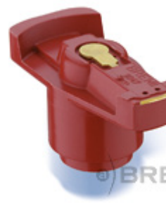
9047 Zündsystem / system Bosch Polyester/Polyester 5000 Ohm entstört/suppressed Verwendung für: / applicable for: VOLVO
