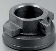
Муфта сцепления ГАЗ 3307, 53, 66, 3308 ПАЗ 3205, ЛЗА 4014
