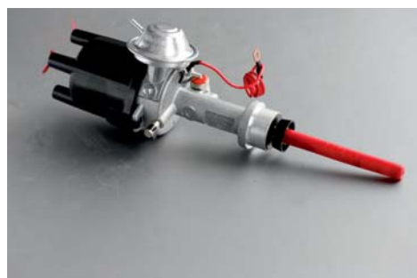
Распределитель зажигания ВАЗ 2101, 2102, 2104, 2105
