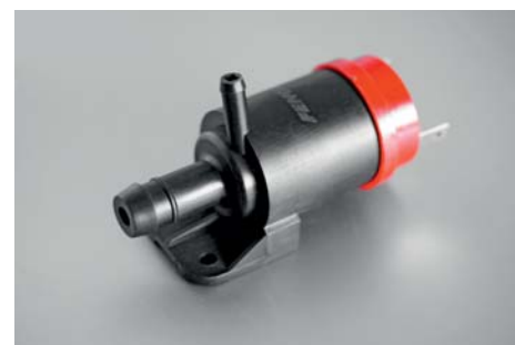
Мотор омывателя BA3 2108–2109 на крыло (старого образца)
