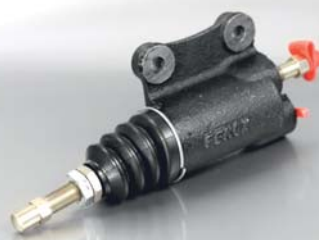
Цилиндр рабочий привода сцепления УАЗ 469, 3151, 31512, 3741, 3962, 2206
